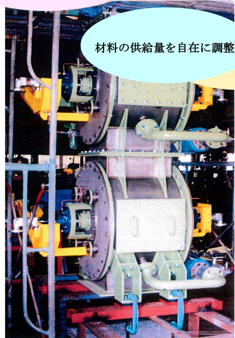
石原工業のロータリーバルブは、一定量の材料供給が行えます。
